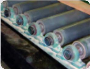
Sobrecalentamiento de los rodamientos para rodillo transportador
