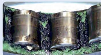
Degradación del lubricante causada por corrientes eléctricas
