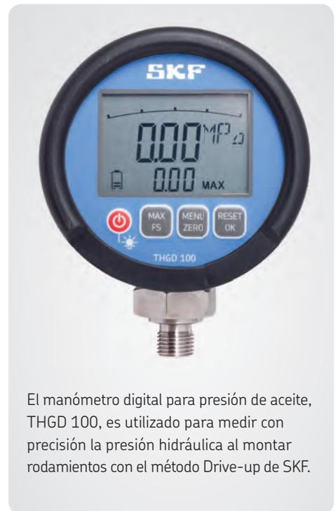
El manómetro digital para presión de aceite, THGD 100, es utilizado para medir con precisión la presión hidráulica al montar rodamientos con el método Drive-up de SKF.
