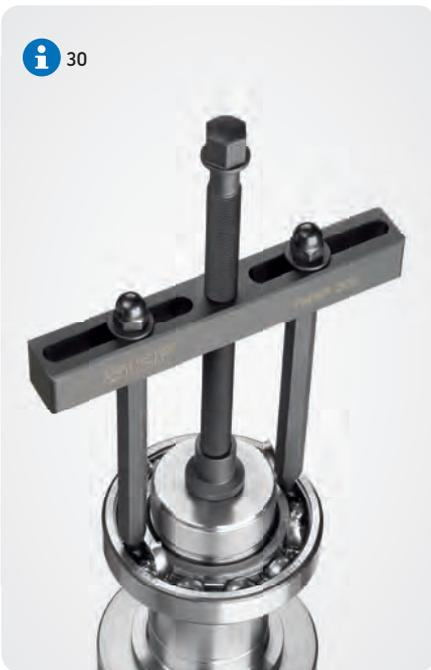
Extrae rodamientos sin desmontar la máquina
