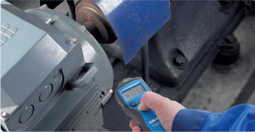
El sistema óptico de láser permite tomar mediciones con rapidez, de manera fácil, segura y a una distancia prudencial de la máquina.
