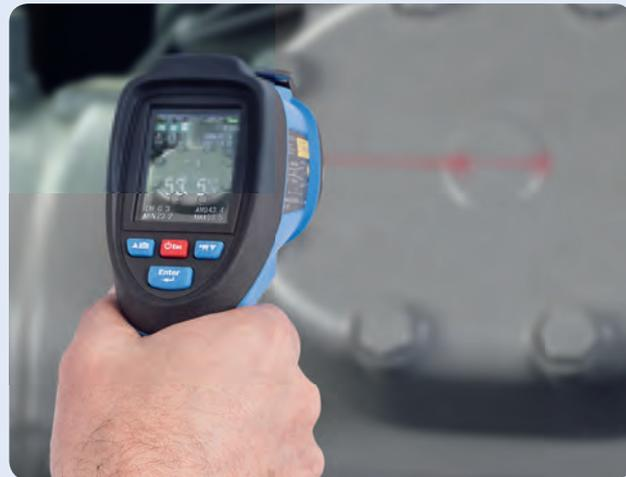
Cuando se usa en modo no-contacto, el termómetro detecta la energía térmica que irradia cualquier objeto gracias a sus infrarrojos. Al señalar un objeto, el detector infrarrojo capta su energía y produce una señal que el microprocesador convierte en una lectura visible en pantalla. Mientras se pulsa el gatillo, el detector infrarrojo mide la temperatura del objeto de forma constante. Este proceso permite realizar lecturas rápidas y precisas en tiempo real.
